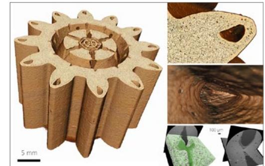
3D-Scan eines durch additive Fertigung hergestellten Al-Bauteils und darin die mit Hilfe von Röntgenmikroskopie abgebildete interne Porosität
