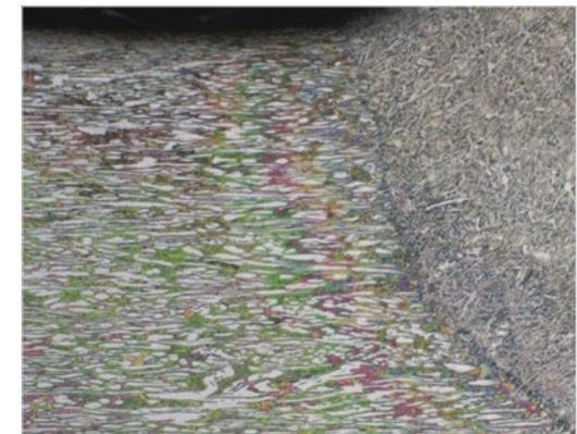
Schnittstelle zwischen Grundmetall und Schweißnaht in Duplex-Edelstahl.
