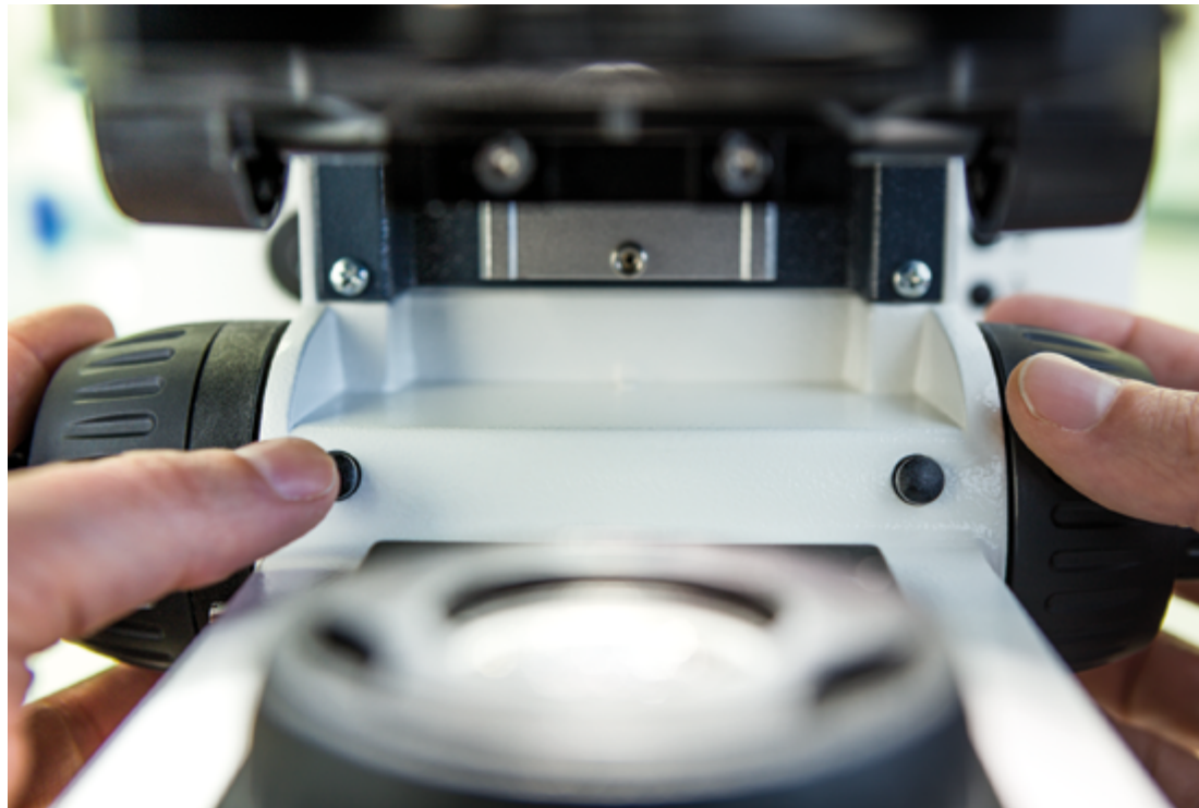
Axioscope 5: beidseitig angeordneter Bildaufnahmeknopf Axioscope 7: Bildaufnahmeknopf (rechts) und Umschaltknopf für die Tischsteuerung (links)
