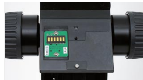
Kontakte der internen Geräte-Codierung
