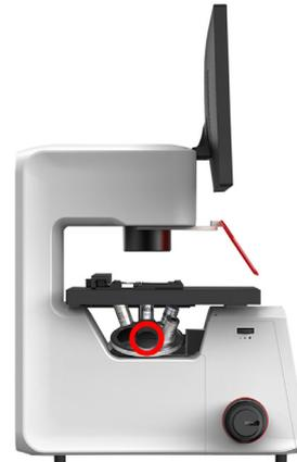
2. Drehen Sie den Objektivrevolver in die freie Position, in der Sie das Objektiv installieren möchten.
