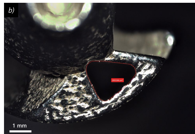
Abbildung 4 Größen- und Geometriemessung mit ZEISS Smartzoom 5: Spitze eines mit dem Additivverfahren hergestellten Schneideinsatzes; a) Überblick, 20x, Ringlicht, HDR; b) Detailansicht und Messung des Kühlkanals, 40x, Ringlicht
