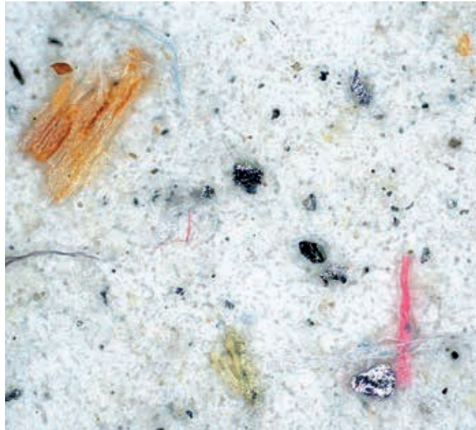
Metallische, nicht-metallische Partikel und Fasern auf Filtermembran Mikroskop: ZEISS Axio Imager.Z2m Objektiv: EC Epiplan-NEOFLUAR 10x/0,25 Kamera: ZEISS AxioCam MRC
