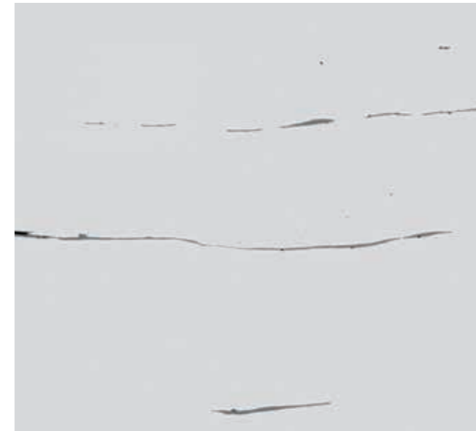
Mit der Aufnahme von Mosaik-Bildern werden auch große Einschlüsse vollständig erfasst. Mit freundlicher Genehmigung: SKF GmbH, Schweinfurt
