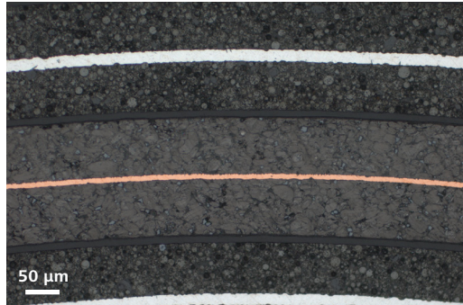
Lithium-Ionen-Batterie. Hellfeld, EC Epiplan 20×/0,4
